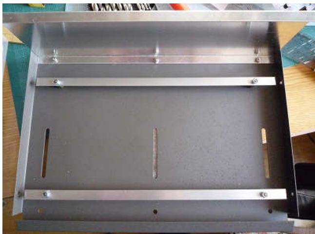
(1) レール取付け
