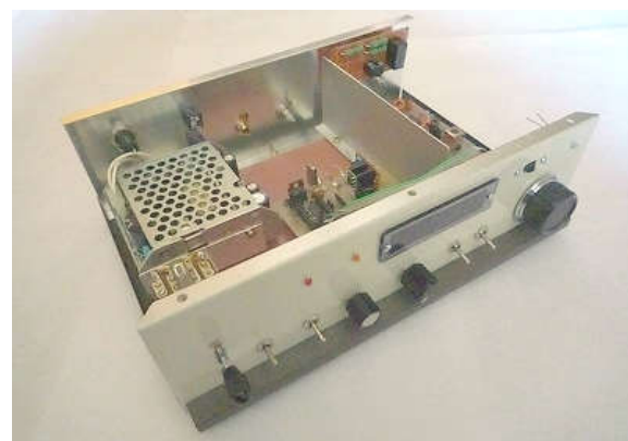
(6) 表面板部品取付け
