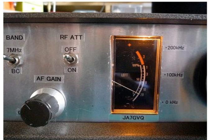
ダイヤル表示用メータ位置5mm上方へ修正穴をアルミ板で塞ぎ、コールサイン貼り付け
